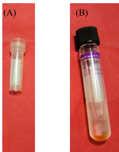
圖 3.15 TB 菌株使用的容器 (A) 帶 O-ring 之檢體小瓶及 (B) BBL™ MGIT™ 培養管。
